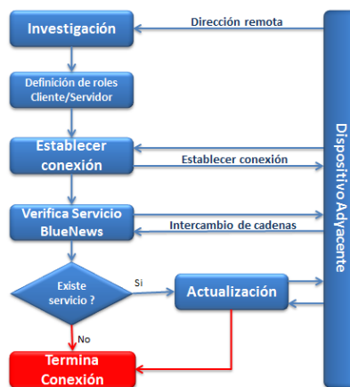
Figura 4. Diagrama de flujo del modo Cliente/Servidor.
